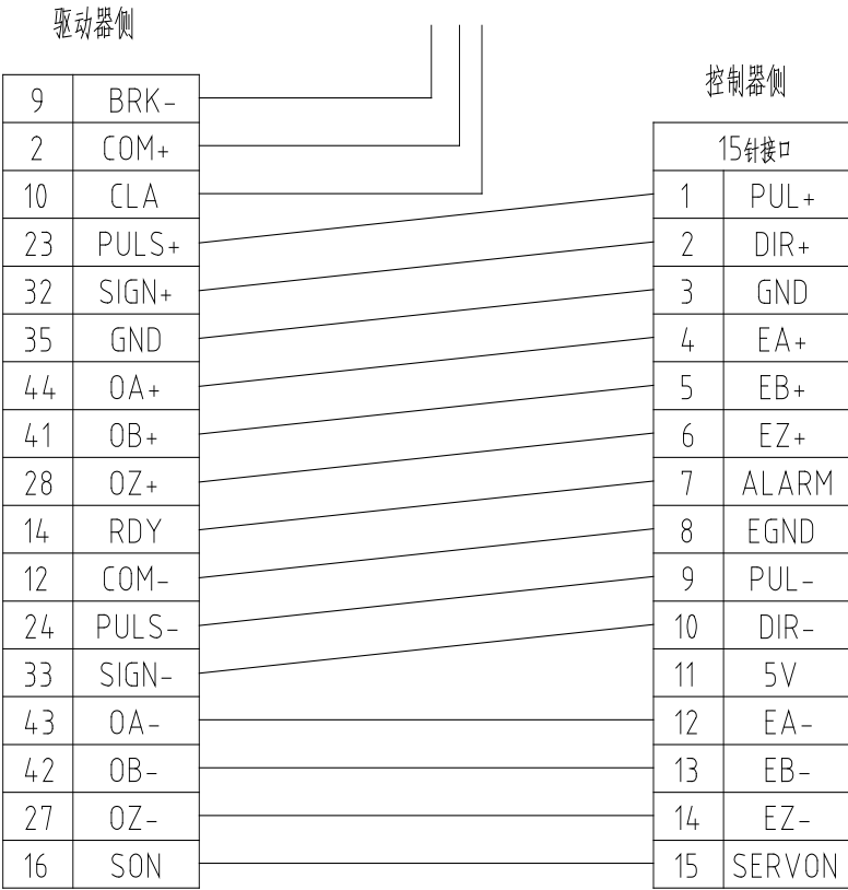
(2) 驱动器 CN1 44 针母头接口与控制器 15 针接口外形图
